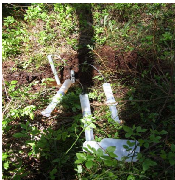
Fot. 2. Pobieranie roztworów wód gruntowych do oznaczeń form biogennych (fot. R. Bennicelli)
