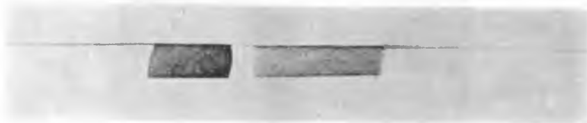
Ryc. 4. Pasek bibuły z zagęszczonymi i rozdzielonymi kationami: miedzi i kobaltu A strip of paper with condensed and separated copper and cobalt cations.
