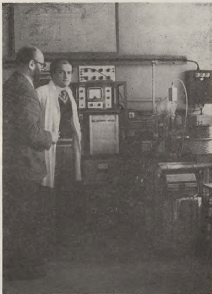
Ryc. 18. Pracownia spektrometrii mas w Zakładzie Fizyki Stosowanej Instytutu Fizyki; cykloidalny spektrometr mas do badań jonizacji gazów elektronami o energii 10\div 1000 eV; przy spektrometrze autor i dr L. Wójcik
