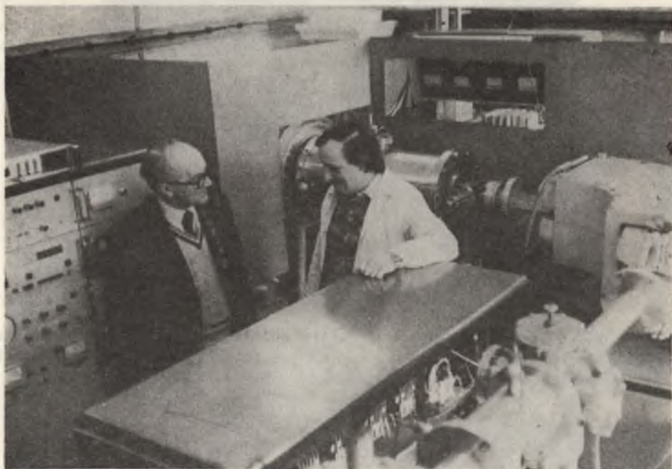
Ryc. 17. W pracowni implantacji jonów Zakładu Fizyki Doświadczalnej IF; przy implantatorze jonów o energii do 200 keV stoją jego główni współtwórcy: prof. M. Subotowicz i dr K. Paprocki
