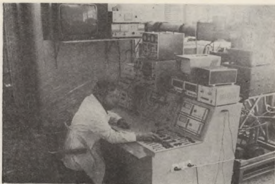
Ryc. 16. Implantator jonów o energii do 350 eV; przy pulpicie sterowniczym mgr J. Ciemniwski
