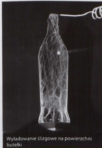
Wyładowania w polach wysokiej częstotliwości generowane transformatorem Tesli
