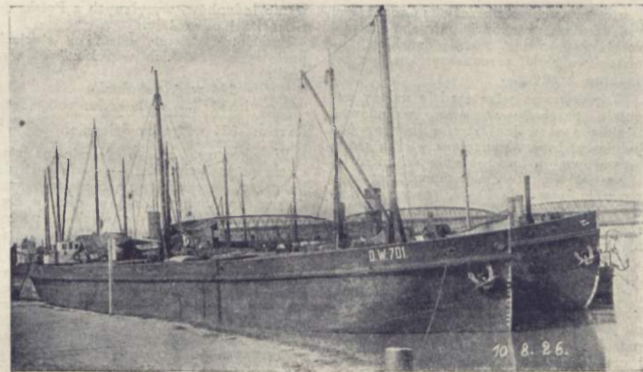
Port w Tczewie: charakterystyczne lichtugi o pojemności 700 ton D. W., którymi jest przewożony węgiel do Skandynawji bezpośrednio z Tczewa. The port of Tczew: typical coal barges of 700 tons D. W. used for carrying coal direct from Tczew to Scandinavian countries.
