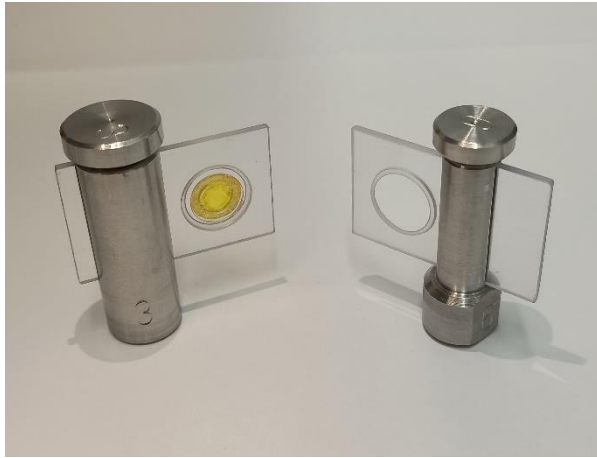
Rys. 22 Komora pomiarowa do próbek biologicznych z oraz bez umieszczonego źródła w przesłonie.
