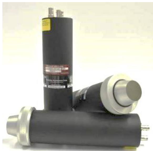
Rys. 14. Zintegrowane detektory scyntylacyjne firmy Scionix.
