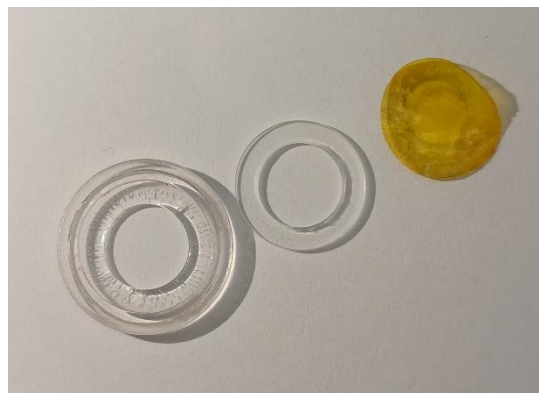
Rys. 21 Od prawej: dwie części oprawki źródła i zamknięte źródło promieniotwórcze ^{22}\text{Na}
