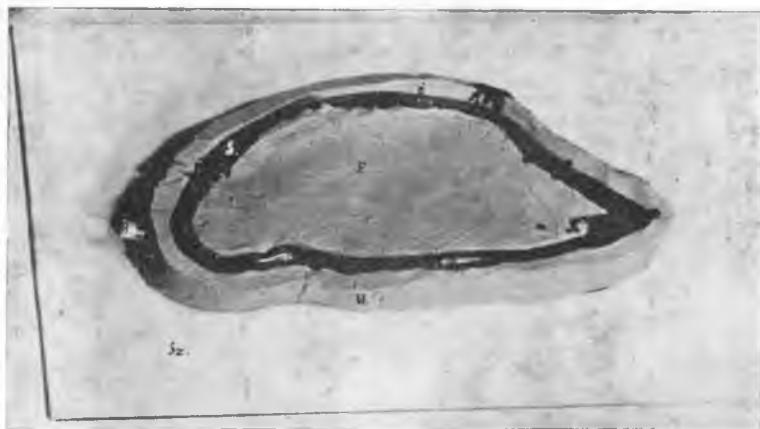
Ryc. 9. Na szybie szklanej wykonano miejsce na preparat oraz wał z masy smołowej. Sz. — szyba szklana. F. — forma z gliny. W. — wał z gliny dookoła formy. S. — masa smołowa pomiędzy formą i wałem z gliny. R. — rurka szklana.
