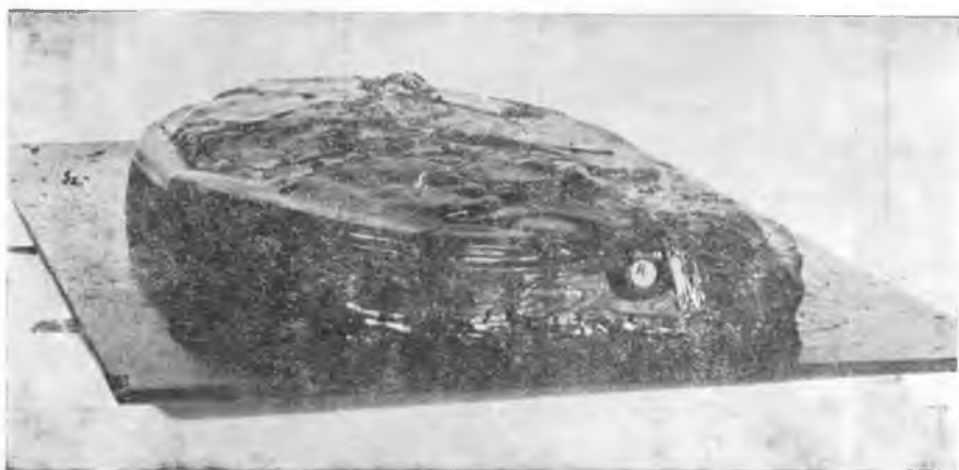
Ryc. 12. Preparat szczelnie zalany masą smołową. Sz. — szyba szklana. S. — masa smołowa uszczelniająca preparat. R. — rurka szklana. K. — korek.
