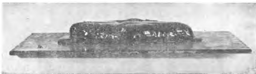
Ryc. 3. Cała powierzchnia preparatu zalana masą smołową. Sz. — Szyba szklana. Pr. — preparat zalany masą smołową.
