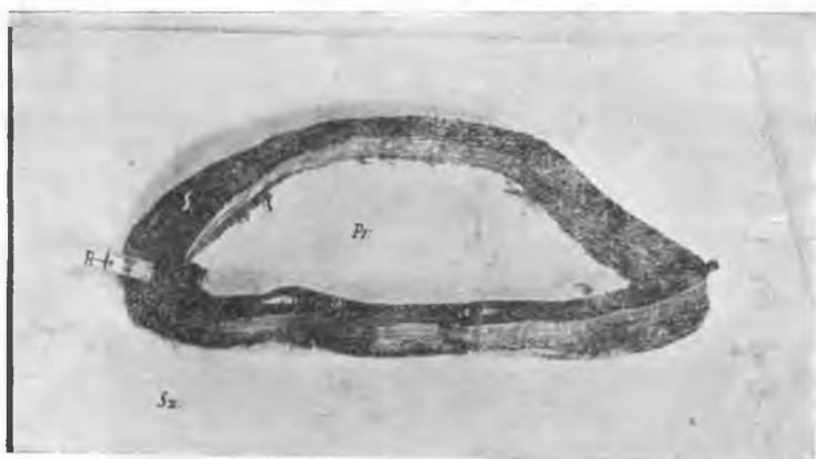
Ryc. 10. Po usunięciu formy i wału z gliny, pozostaje wał z masy smołowej. Sz. — szyba szklana. S. — wał z masy smołowej. Pr. — miejsce na preparat. R. — rurka szklana.
