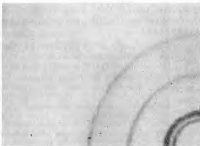
Ryc. 3. Chromatogram krążkowy mieszaniny kationów \text{Cu}^{++} , \text{Co}^{++} \text{Fe}^{++} (stężenie po 1 \gamma ) wywołane odczynnikiem IIa Circular chromatogram of the mixture of the cations \text{Cu}^{++} , \text{Co}^{++} and \text{Fe}^{++} (concentration 1 \gamma ) detected by reagent IIa
