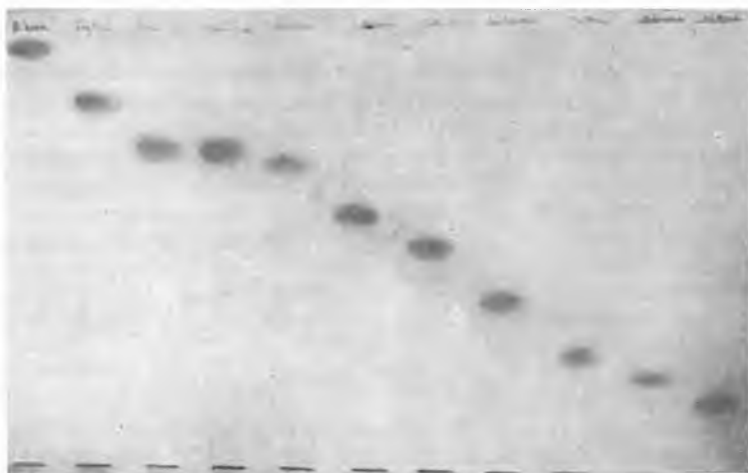
Ryc. 1. Wpływ metody chromatograficznej wstępującej na wartość R_F Influence of ascending chromatography method on the R_F value
