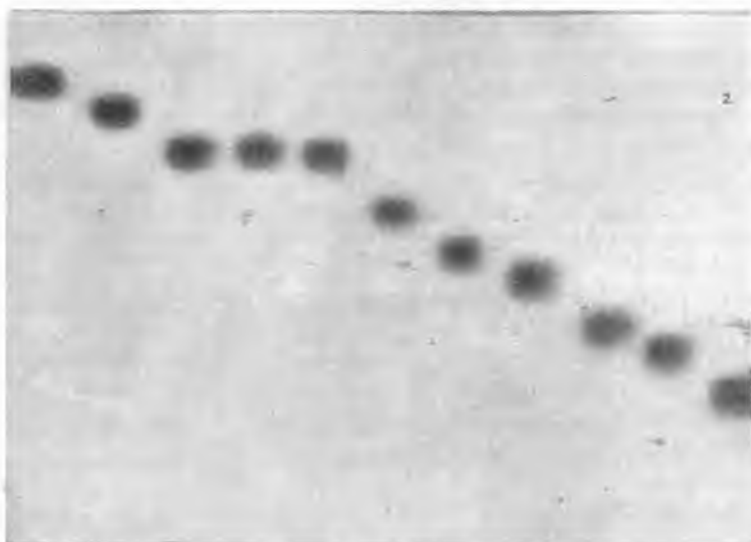
Ryc. 2. Wpływ metody sływowej (zstępującej) na wartość R_F Influence of descending method on the R_F value
