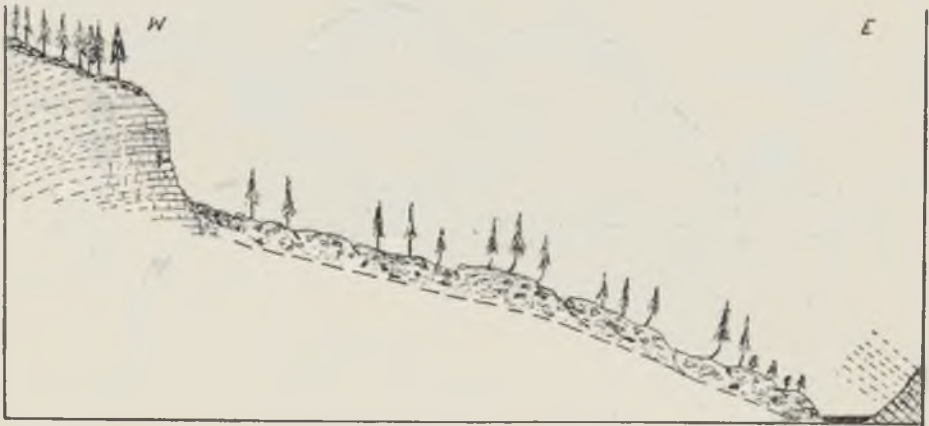
Ryc. 7. Schematyczny profil osuwiska na wschodnim zboczu Kamienki w pobliżu wsi Krzeczkowa
