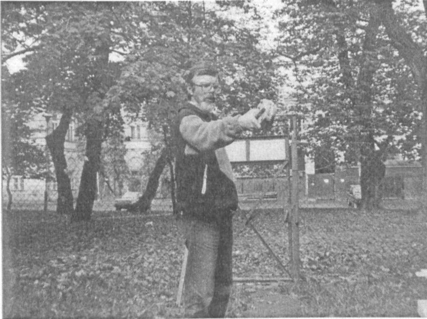
Fot. 1. Pomiar zapylenia powietrza za pomocą konimetru w Obserwatorium Meteorologicznym UMCS w Lublinie
