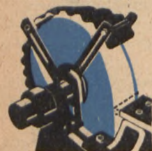
Wspornik umieszczony za daleko
