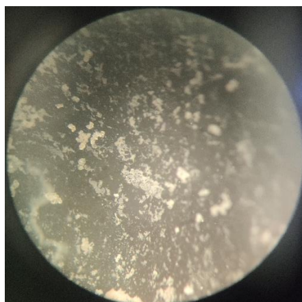
Rysunek 37. Widok kryształów BHDB pod mikroskopem optycznym. a) kryształy otrzymane w wyniku krystalizacji z acetonitrylu; b) kryształy otrzymane w wyniku mielenia.
