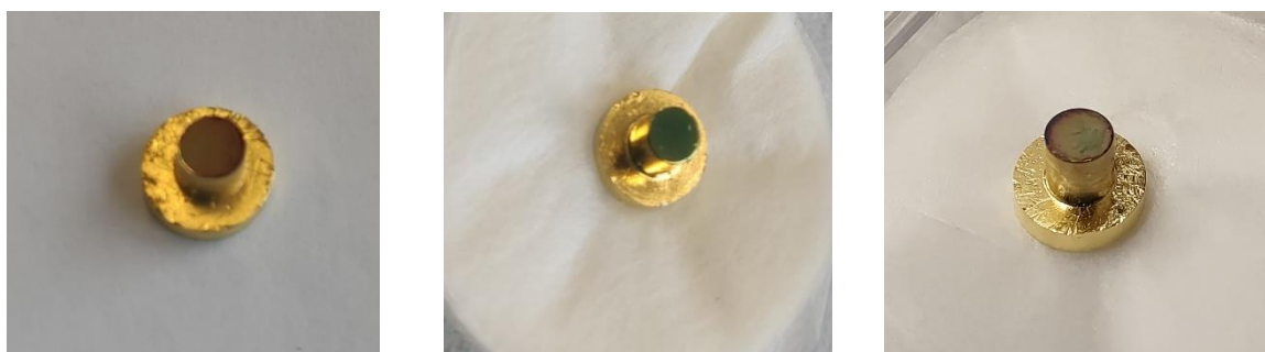
Rysunek 108. Przykładowe kryształy Au(111) z naniesionym filmem tlenku kobaltu. Próbką powinna być homogeniczna jak w pierwszych dwóch przypadkach, ostatnia próbka pokazuje warstwę, które charakteryzuje się heterogenicznością warstwy.
