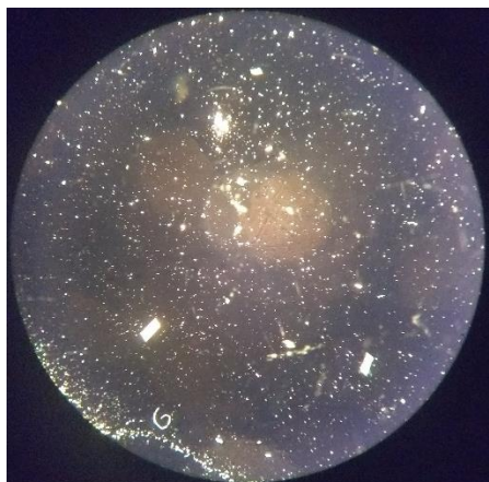
Rysunek 37. Widok kryształów BHDB pod mikroskopem optycznym. a) kryształy otrzymane w wyniku krystalizacji z acetonitrylu; b) kryształy otrzymane w wyniku mielenia.
