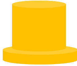
Rysunek 94. Geometria otrzymanych cylindrycznych kryształów Au(111).
