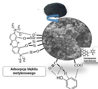
Rysunek 7. Przewidywany mechanizm adsorpcji błękitu na taninowo-bentonitowych materiałach węglowych [D3].
