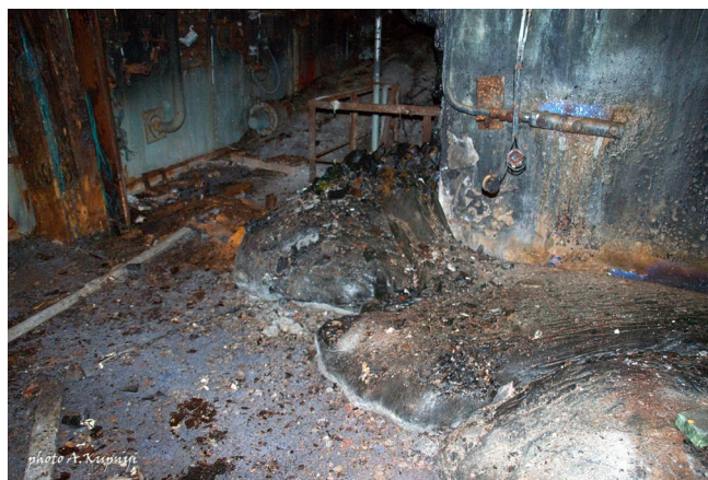
Rys. 9. Zastygnięta radioaktywna lava pod powierzchnią reaktora nazywana „Stopą słonia” (źródło: [20]).
