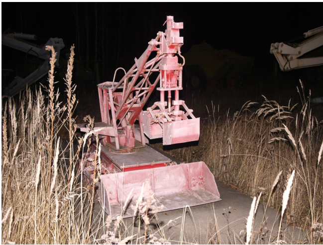
Rys. 10. Robot, który pracował w silnie skażonej strefie przez dwa miesiące (cały okres likwidacji) (źródło: materiał własny).
