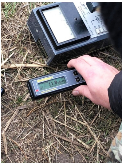
Rys. 18. Pomiar mocy dawki promieniowania przy chwytaku, który przeniósł radioaktywne odłamki reaktora (źródło: materiał własny).
