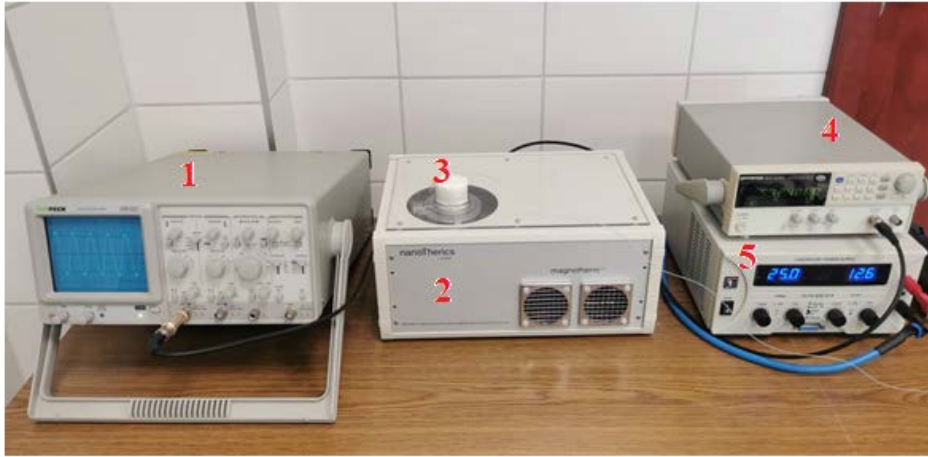
Rysunek 26. Układ pomiarowy: 1-oscyloskop, 2-obudowa mieszcząca cewkę wzbudzącą, 3-forma z polistyrenu, 4-generator funkcyjny, 5-wzmacniacz mocy tworzący obwód rezonansowy.
