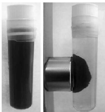
Rysunek 28. Magnetyczna separacja superparamagnetycznych nanocząstek rozdystrybuowanych w wodzie. Po lewej jednorodna zawiesina nanocząstek magnetycznych w wodzie, po prawej nanocząstki przyciągnięte do boku magnesu neodymowego po 5 minutach.
