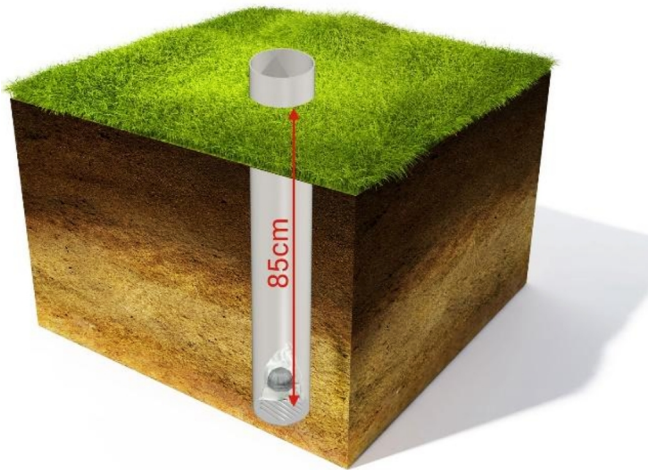
Rys. 5. Schemat pomiaru radonu w powietrzu glebowym z użyciem detektorów pasywnych [7].
