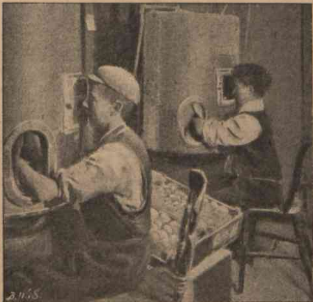
Przyrząd ochraniający przed potykaniem ostrego kurzu przy polerowaniu.
