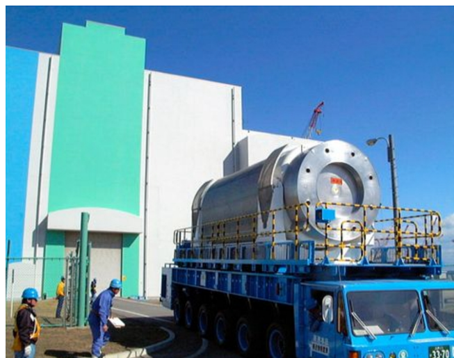
Rys. 4. Przywóz wypalonego paliwa w pojemniku transportowym do zakładów Rokkasho Japonia (JNFL)
