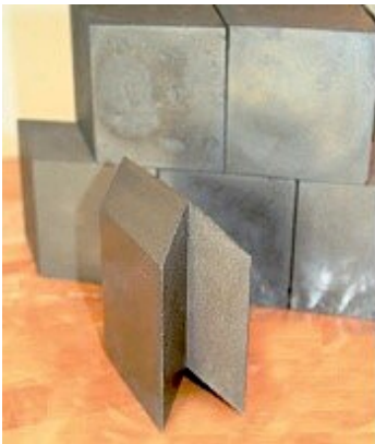
Fot. 4. Cegły wykonane z kompozytu Fe/epoxyda.
