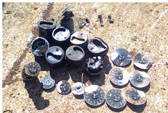
Fot. 1. Elementy urządzeń pokryte farbą radową (fot. CMC Poland).
