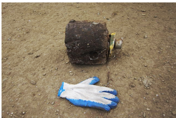
Fot. 3. Uszkodzony pojemnik osłonowy źródła promieniotwórczego (fot. PAA).
