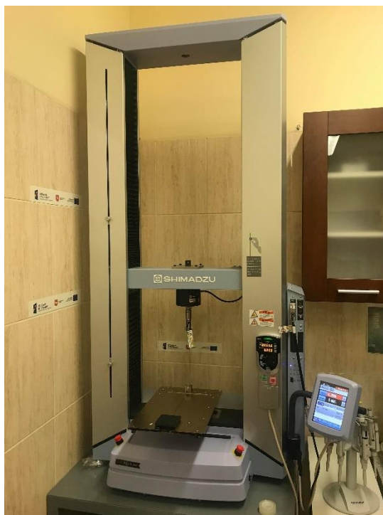
Rys. 15. Maszyna wytrzymałościowa z przystawką do badania COF zgodna z normą ASTM D1894.
