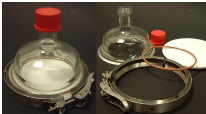
Rys. 13. Komora migracyjna typ „D” zgodna z normą PN-EN 1186-1.
