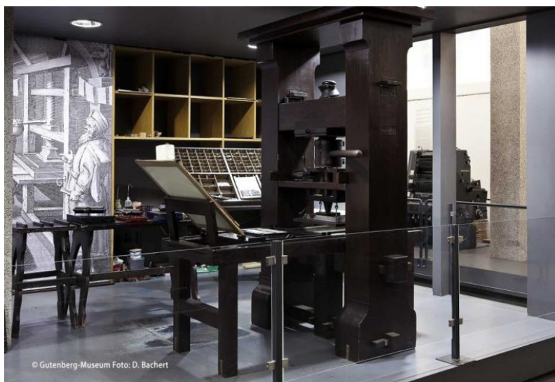
Rys. 1. Prasa drukarska Gutenberga (wg [7]).
