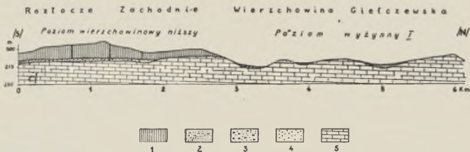
Ryc. 7. Przekrój geologiczno-morfologiczny przez północną krawędź Roztocza koło Aleksandrówki, wzdłuż działu wodnego Bystrzyca—Por; 1 — less (złodowacenie bałtyckie), 2 — deluwia piaszczyste (plejstocen), 3 — glina morenowa (złodowacenie krakowskie), 4 — piaski kwarcowe (torton), 5 — opoka (kreda górna)
