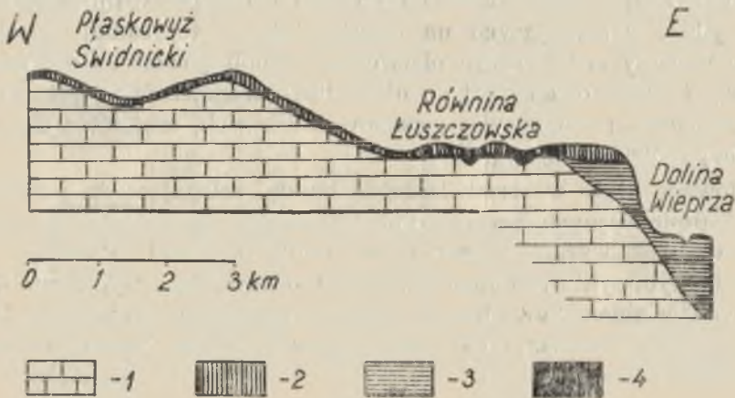
Ryc. 2. Przekrój geologiczny przez badany obszar; 1 — kreda (skała kredowa), 2 — piaski i mułki terasowe, 3 — utwory lessopodobne, 4 — osady organogeniczne (Holocen)
