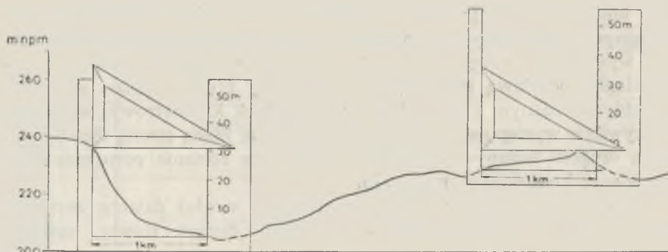
Ryc. 1. Wyznaczanie wysokości względnych wzdłuż działu wodnego przy pomocy ruchomej miarki. Przykład z działu pomiędzy zlewniami Chodelki i Nędznicy (Bystrzyca spod Sobieszcza)
