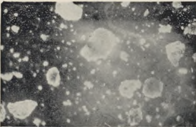
Fot. 8. Dolno-oligoceni piasek glaukonitowy z Jakubowic. W polu widzenia drobne ziarna kwarcu, glaukonit i minerały ilaste. Nikole nieco skrzyżowane; powiększenie ok. 60 x.
