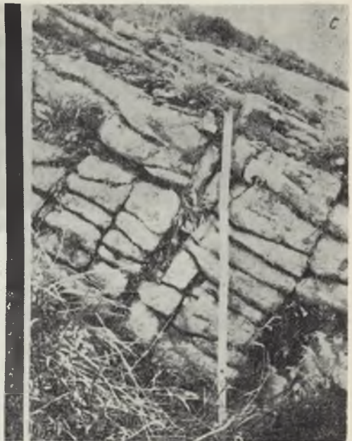
Ryc. 13. a, b, c — wietrzenie mechaniczne i chemiczne piaskowców, uzależnione od charakteru spękań tektonicznych a, b, c — mechanical and chemical weathering of sandstones depending upon the character of joints
