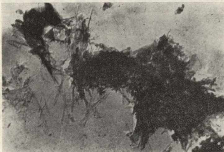
Ryc. 5. Struktura zaczynu magnezjowego zarabianego wodą po 28 dniach przechowywania w warunkach powietrznie suchych. Widoczne cienkie igły Mg(OH)_2 , tworzące rodzaj nalotów na powierzchni ziarn MgO . Mikroskop elektronowy, replika pośrodkowa węglowa, pow. 18 000 ×
