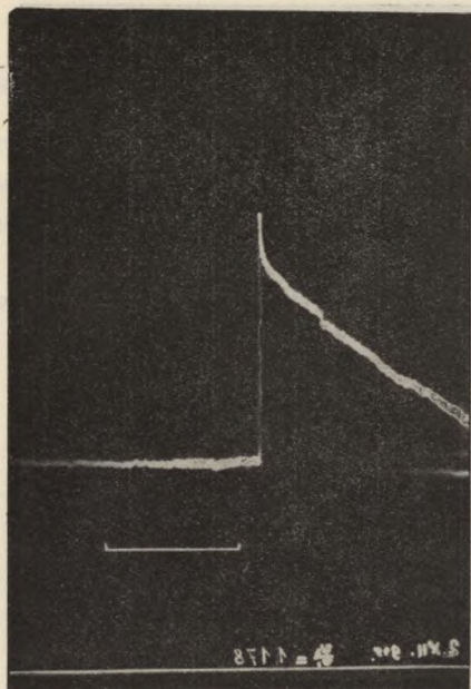
Rys. 11. Oscylogram rozprężenia w komorze Wilsona. Zdjęcie robione bez nakładki. Dorysowany na dole poziomy odcinek oznacza 1 sek. Napięcie wyłączone, w pobliżu komory preparat jonizujący. \frac{v_2}{v_1} = 1,178 .
