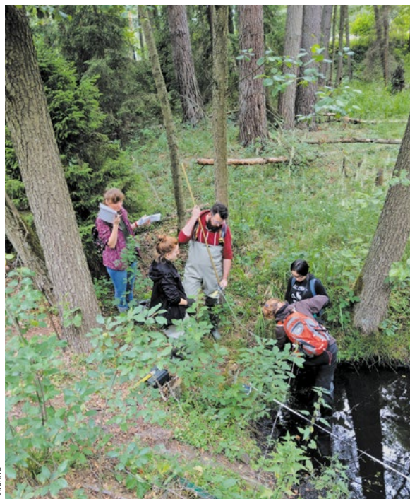
← Pomiar przepływu na rzece Świerszcz
