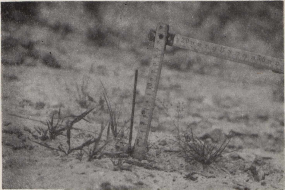
Fot. 2. Szpilka stalowa służąca do pomiaru splukiwania A steel pin used for taking washing measurements
