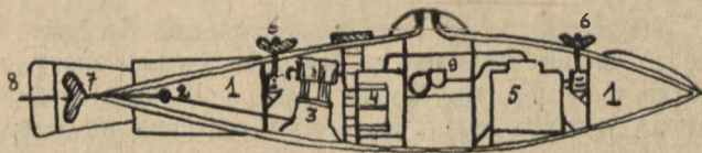
Rys. 6. Łódź podwodna Nordenfelda. 1 — komory balastowe, 2 — krzyżulec, 3 — maszyna parowa, 4 — komora parowa, 5 — zbiornik do magazynowania pary, 6 — śruby płonowe, 7 — śruba napędowa, 8 — ster, 9 — postereunek centralny
