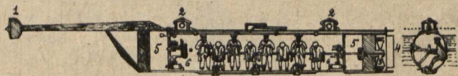
Rys. 4. „David“ Hunleya. 1 — mina na wysuniętej belce, 2 — luk wejściowy, 3 — śruba napędowa, 4 — silnik, 5 — komory balastowe, 6 — pompy do komór balastowych
