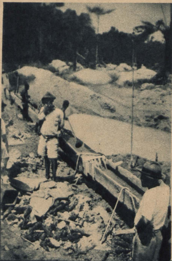
Przeplukiwanie piasku zawierającego złoto
