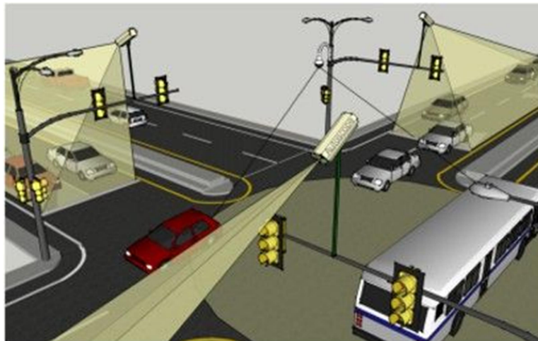
Rysunek 9. Przykładowe rozmieszczenie kamer rejestrujących na skrzyżowaniu
