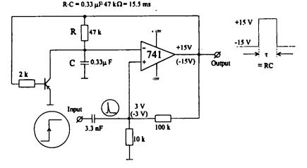
Fig. 5. Monostable multivibrator circuit based on operational amplifier 741 and p-n-p transistor (e.g. BC 393) Obwód uniwibratora wykorzystujący wzmacniacz operacyjny 741 oraz tranzystor p-n-p (np. BC393)
