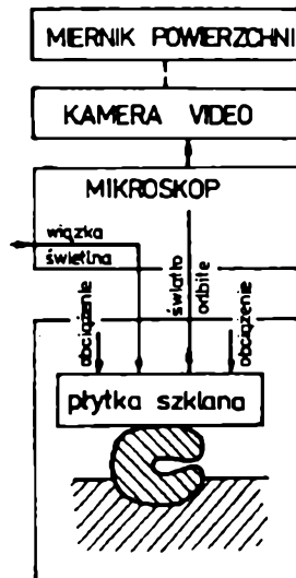
Ryc. 1. Schemat układu pomiarowego rzeczywistej powierzchni kontaktu
